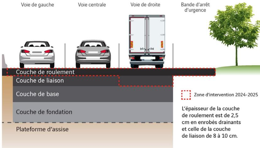
Ces travaux consistent à **raboter et à refaire les enrobés** de la couche de roulement en béton bitumineux très mince (BBTM) sur 2,5 cm d'épaisseur, sur toutes les voies de circulation. Une couche de liaison en grave bitume (GB) sera quant à elle reprise sur 8 à 10 cm d'épaisseur pour la voie de droite.
